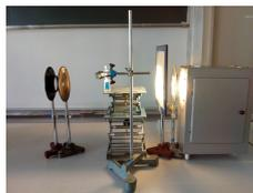
FIGURE 8 – Montage pour la loi de Jurin : projection sur un écran
