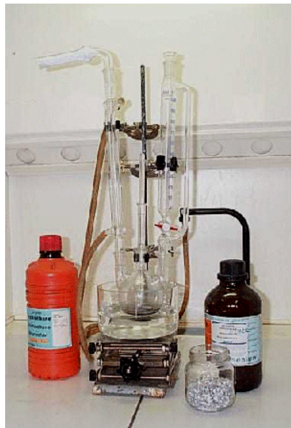
FIGURE 32.29 – Dispositif expérimental pour la synthèse d'un organomagnésien
