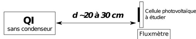
FIGURE 4 – Éclairage de la cellule photovoltaïque
